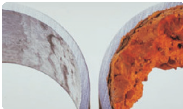
Rura bez osadu VS. mocno skorodowana rura ocynkowana
